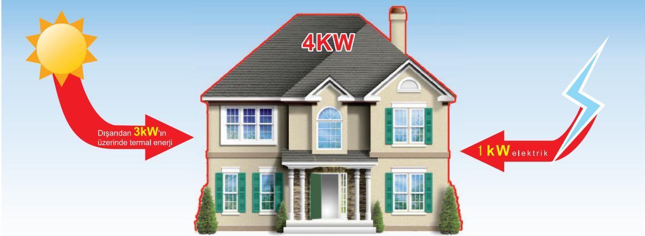
Isı pompaları dış ortam havasından termal enerjiyi absorbe eder. Heat pump üniteleri dış ortam havasından aldığı 3 kW'lık enerjiyle birlikte toplamda 4kW'lık bir ısıtma enerjisi verebilmesi için sadece 1 kW'lık bir elektrik enerjisi tüketir.
