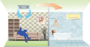
Isı geri kazanım teknolojisinin verimi sayesinde dış ünite soğutmada çalışırken iç ünitelerden elde edilen ısı geri kazanılır ve kazanılan bu enerji ile kullanım sıcak suyu elde edilir.
